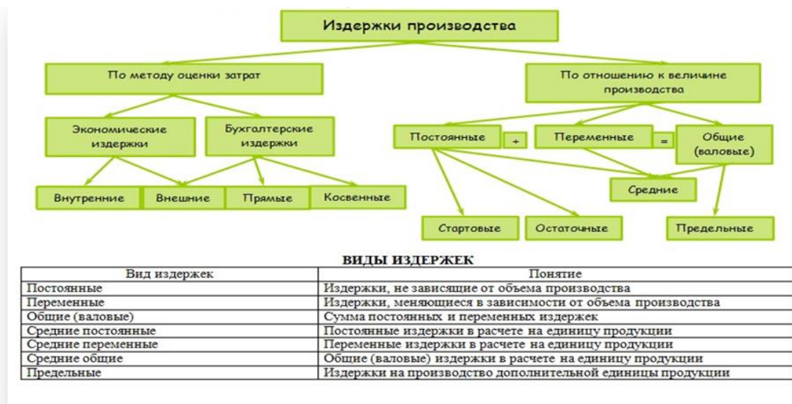
Рисунок 6 – Классификация издержек производства
