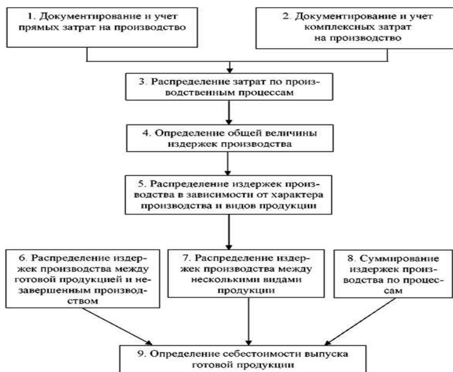
Рисунок 21 – Формирование затрат на производство продукции в попроцесном калькулировании
