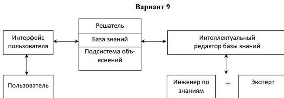
Рис. 4.9. Структура экспертной системы
