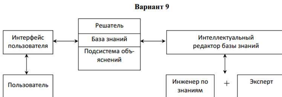
Рис. 4.9. Структура экспертной системы
