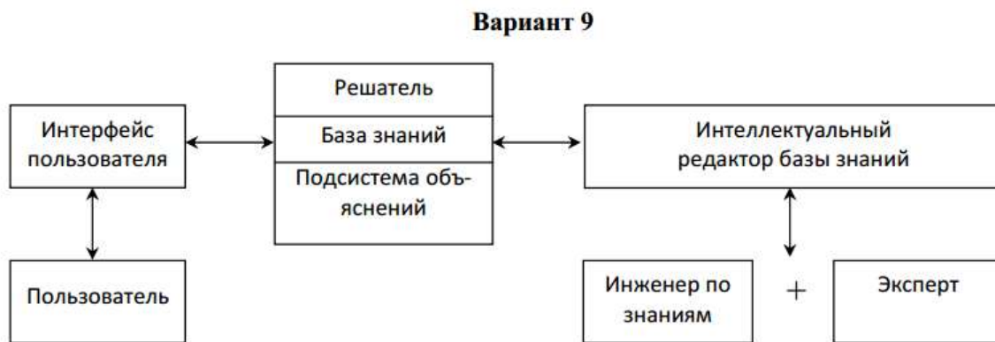
Рис. 4.9. Структура экспертной системы
